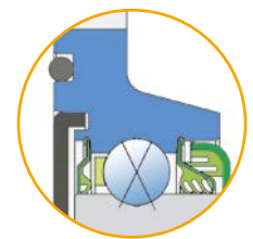
Уплотнительное кольцо + защитная металлическая крышка + уплотнение S/ Двойное трехкромочное уплотнение с усиленной шайбой
