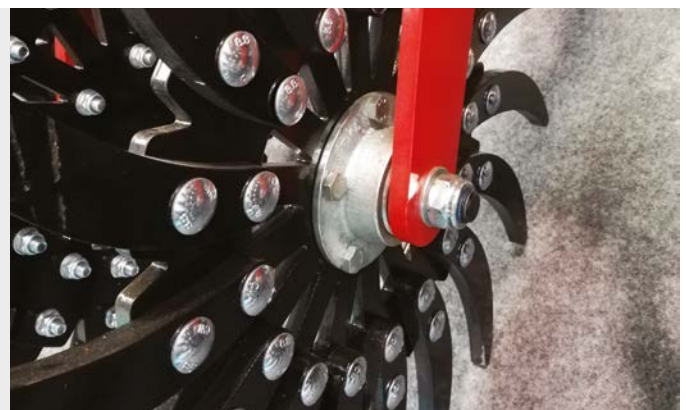
Уплотнительное кольцо + защитная металлическая крышка + уплотнение S/ Двойное трехкромочное уплотнение с усиленной шайбой
