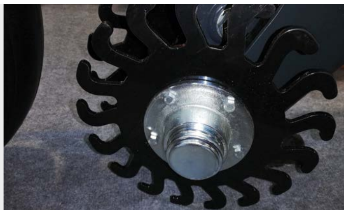
Трехкромчатое уплотнение/ Трехкромчатое уплотнение + защитная металлическая крышка
