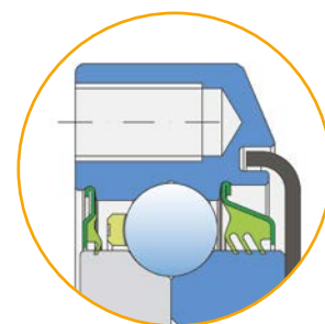
Уплотнение S/ Трехкромочное уплотнение + металлическая крышка
