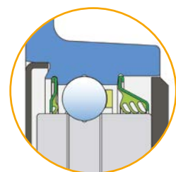
Защитная металлическая крышка + уплотнение S/ Трехкромчатое уплотнение + защитная крышка
