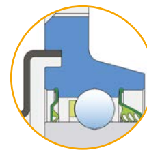
Защитная металлическая крышка + уплотнение S/ Трехкромочное уплотнение
